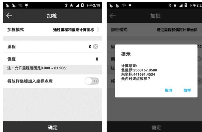
④：加桩，如图 5.5-5 所示，可在进行直线放样时加桩。加桩模式有两种，一是通过里程和偏距计算坐标，在输入值中输入里程和偏距；二是通过坐标计算里程和偏距，在输入值中输入北坐标、东坐标、高程或者直接从坐标点库中查找或者通过获取当前 GPS 坐标。设置完成后点击[确定]，弹出提示框如图 5.5-6 所示，显示计算结果，点击[放样]即进行点放样界面进行放样。
