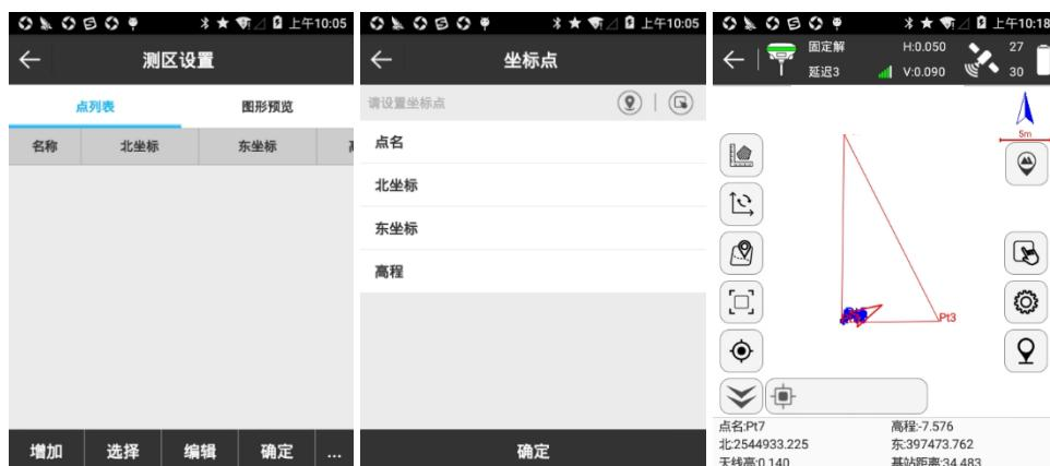
选中坐标点，点击[编辑]，可重新编辑坐标点数据；点击[删除]，如图 5.17-4 所示，在弹出的删除提示信息中点击[确定]即可删除该条数据；点击[上移]，即可让选中数据上移，点击[下移]，即可让选中数据下移。点击[图形预览]，如图 5.17-5 所示，可以根据点列表里面的点画出图形，点击[CAD]可直接进入 CAD 功能，如图 5.17-6 所示。
