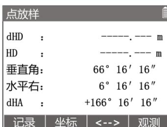
在{点放样}坐标法界面，按[F2] **【平距/坐标】**。进入如图角度距离法界面。
