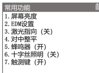
一些常用功能可以在各个测量界面中按[★]键直接调用。如果{对中整平}界面没有自动出现，可在常规测量界面按[★]键进入{常用功能}菜单。
