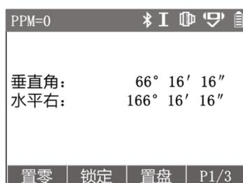
常规测量界面顶端状态栏为当前测量状态图标，从左至右依次为 PPM 常数、蓝牙功能状态、正倒镜状态、棱镜模式状态、补偿器状态、电池状态。
