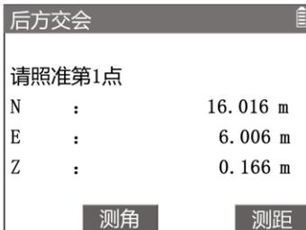
在{后方交会}照准测量界面可以选择【测距】、【测角】两种方式。测角是只进行测角，不进行测距，瞄准目标按 F4[是]即可。
