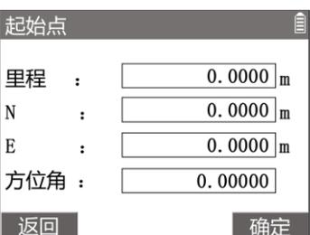
在{定义水平定线}中，选择[2]〈线元法〉，进入线元法输入{起始点}界面。
