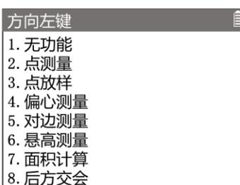
以左键[◀]设置为例:按[1]〈方向左键〉,进入{方向左键}测量程序选择界面。再按[4]〈偏心测量〉。
