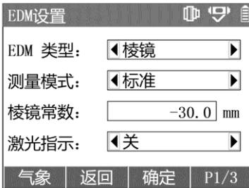
在{仪器设置}界面按[4]〈EDM 设置〉进入{ EDM 设置}界面。
