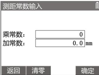
**【常数】:** 此界面可以通过直接输入测距〈乘常数〉和〈加常数〉对测距数据进行修正。
